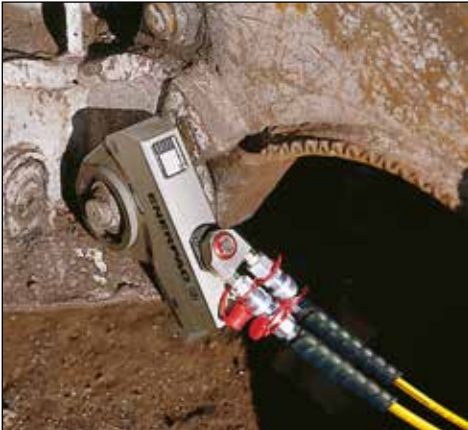
◀ Enerpac HXD serisi tork anahtarları kullanarak sahada kolay ve güvenilir servis.
